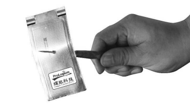
图2:锂陶瓷电池安全性测试
